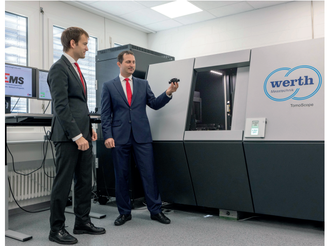
Bild 2. Bei EMS-GRIVORY wird das Werth TomoScope S vor allem zur Messung von Kundenbauteilen, sowie zur Analyse von Faserorientierung und Lunkern eingesetzt. Ruedi Portmann (links), Leiter des CAE-Service, und sein Team unterstützen damit Kunden bei der Entwicklung. © EMS-GRIVORY
